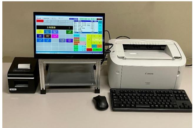
図1 開発した発券システムのプロトタイプ機
