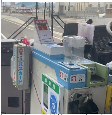
既存の運賃箱に乗車、降車用を貼り付けて設置
