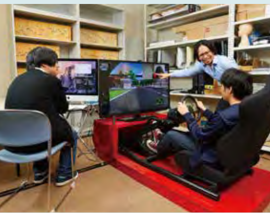
これまでのセンシング技術を応用し、ドライバーの視線の動きを計測する「先端カーシミュレータ」。
