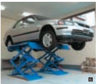
1 「リアルタイム運転シミュレータ装置」での実験の様子。この実験室には脳波や眼球運動の測定器なども設置。 2 46インチのディスプレイ27面を並べた大型高精細可視化装置を備える「3次元実験室」。 3 i-MOSには専任のプロジェクト研究員を配置。センター内機能の案内を始め、様々な研究をサポート。 4 多様な刺激条件における被験者の脳波を測定する「生理指標測定装置」。様々な分野の研究に使用可能。 5 組込みソフト技術者を対象に教育活動にも取り組み、今年度15講座203時間に及ぶ講習会を実施。 6 人間工学実験室に設置された、エア駆動のリフト。 7 「インテリジェントブレーキ制御システム」の共同研究に取り組む、(有)中央車体の千葉和幸会長(右)、河野准之さん(左)と新井義和准教授(中央)。
