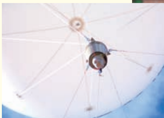
柴田教授が研究を進める気球搭載全方位映像監視システムに利用される気球とPTZカメラ(パン・チルト・ズーム一体型監視カメラ)
