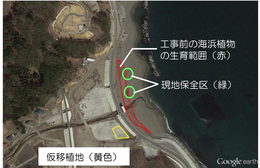
図1 工事前の十府ヶ浦米田地区の空中写真 現地保全区・仮移植区を追加した
