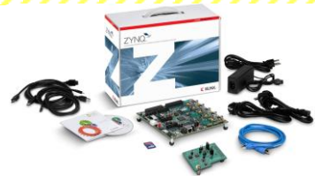
ザイリンクス Zynq-7000 All Programmable SoC ZC702 評価キット(型名:EK-Z7-ZC702-G-J)
